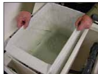
Enlèvement des matières capturées par filtrage
